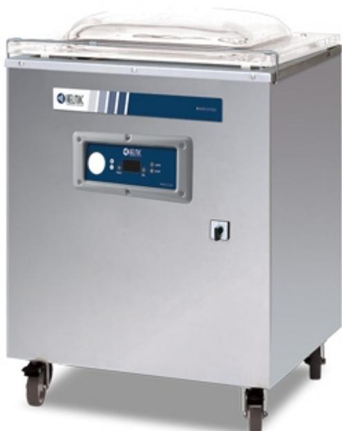
Emballeuse sous-vide à cloche sur chariot en acier inox, avec un cycle d'emballage complètement automatique et un panneau de commande numérique avec 10 programmes configurables.
