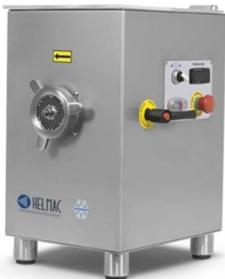
Hachoir à viande réfrigéré avec trémie amovible avec capteur de sécurité, entièrement fabriqué en acier inox. Système Enterprise 32. Moteur à ailettes et auto-ventilé pour un meilleur refroidissement. Groupe frigorifique avec compresseur et condenseur. Pieds robustes en acier inox autonivelants et antidérapants.
