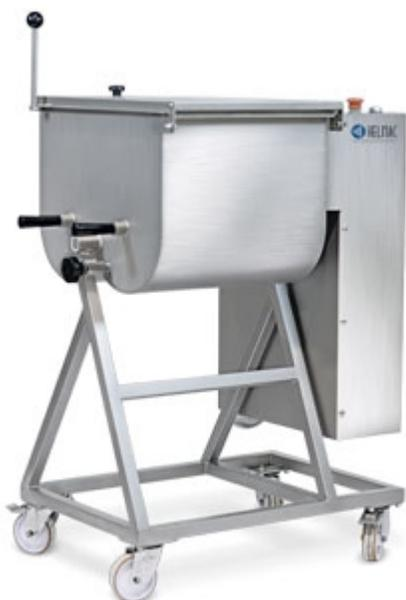
Mélangeur double pales en acier inox doté de cuve basculante pour un meilleur déchargement du mélange. Le couvercle est doté d'ouvertures pour l'introduction des arômes durant la transformation. La cuve est montée sur un châssis doté de roues pivotantes, dont deux avec frein. Le motoréducteur à deux sorties à vis sans fin garantit une synchronisation parfaite des pales. Inversion du sens de rotation à impulsion.
