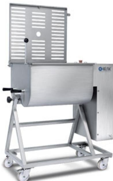
Mélangeur double pales en acier inox doté de cuve basculante pour un meilleur déchargement du mélange. Le couvercle est doté d'ouvertures pour l'introduction des arômes durant la transformation et d'un micro-interrupteur magnétique de sécurité. La cuve est montée sur un châssis doté de roues pivotantes, dont deux avec frein. Le motoréducteur à deux sorties à vis sans fin garantit une synchronisation parfaite des pales. Inversion de marche à impulsion.
